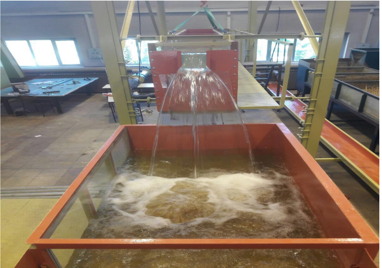
Resim 6. Oyulma deney çalışması
